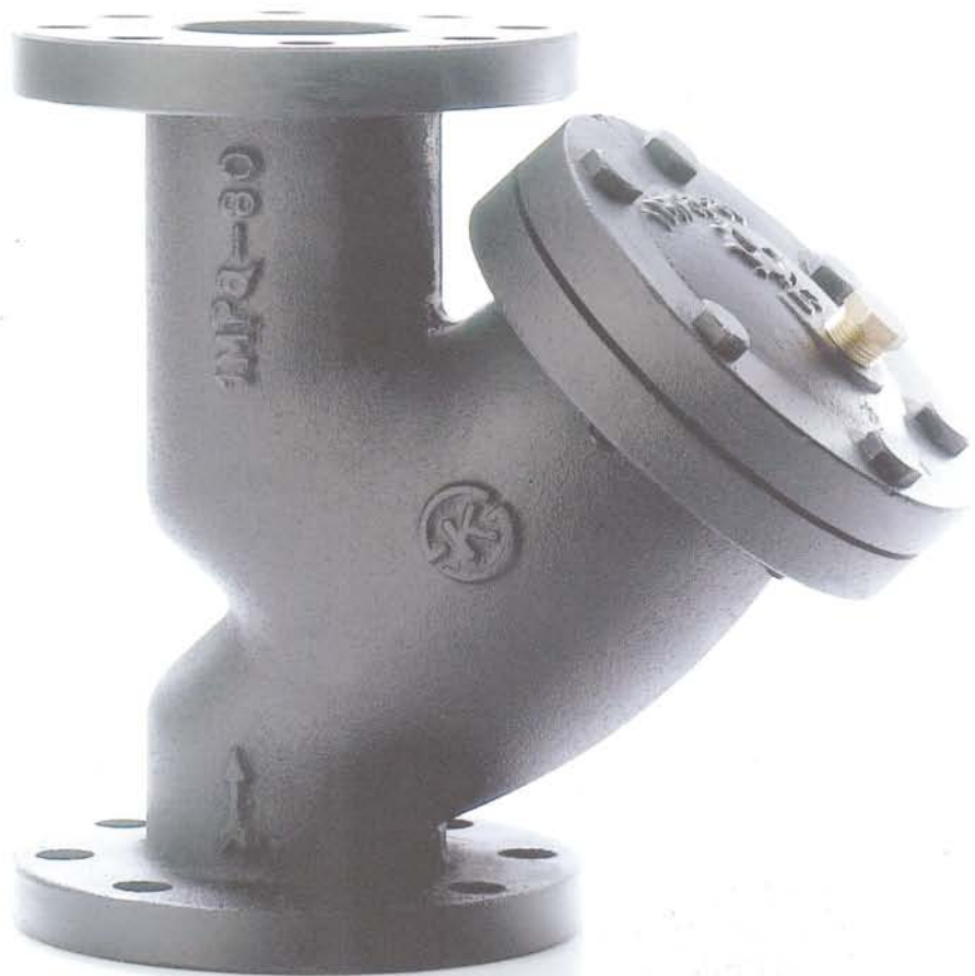
적용규격 : 200A 덮개를 고리형태로 개발하여 여과망 청소시 작업이 용이함.
